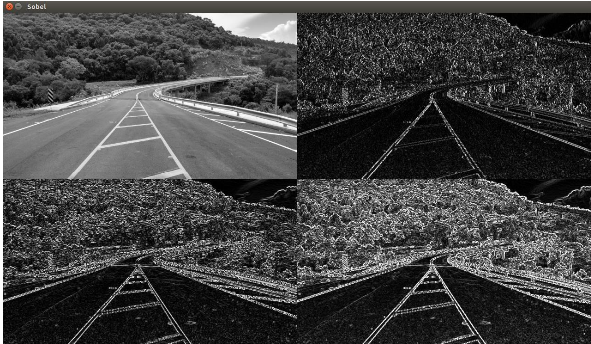
Figura 39 Da esquerda para a direita e de cima para baixo temos: a imagem original, Sobel Horizontal (sobelX), Sobel Vertical (sobelY) e a imagem com o Sobel combinado que é o resultado final.
