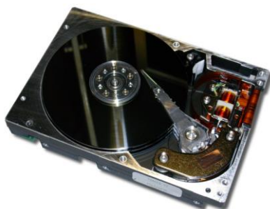
Figura 4 HD: Hard Disk ou Disco Rígido "por dentro"
