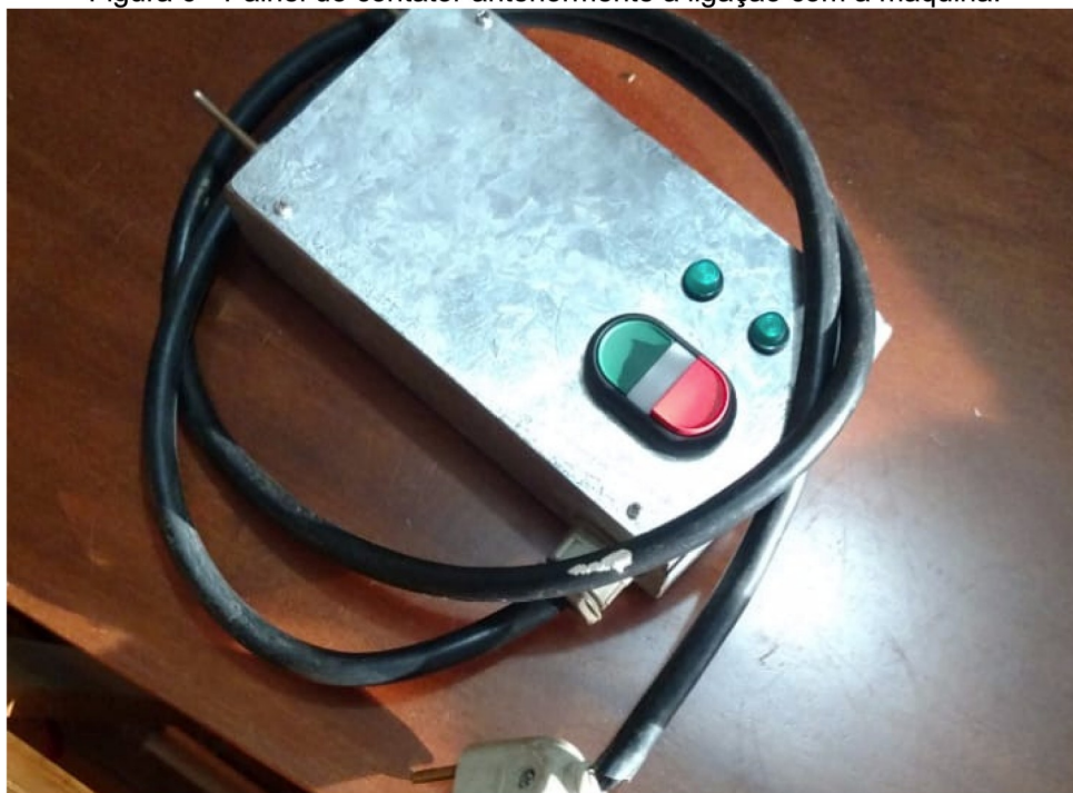
Figura 6 - Painel do contator anteriormente a ligação com a máquina.
