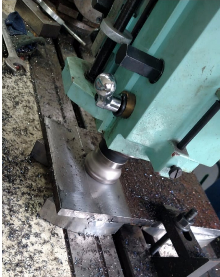
Figura 4 - Fresamento da base do equipamento.
